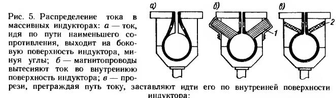
Рис. 5. Распределение тока в массивных индукторах: *а* — ток, идя по пути наименьшего сопротивления, выходит на боковую поверхность индуктора, минуя углы; *б* — магнитопроводы вытесняют ток во внутреннюю поверхность индуктора; *в* — прорези, препрятствия пути току, заставляют идти его по внутренней поверхности индуктора:
