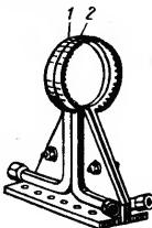
Рис. 6. Индуктор для закалки непрерывно-последовательным способом:
