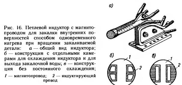
Рис. 16. Петлевой индуктор с магнитопроводом для закалки внутренних поверхностей способом одновременного нагрева при вращении закаливаемой детали: а — общий вид индуктора; б — конструкция с отдельными камерами для охлаждения индуктора и для выхода закалочной воды; в — конструкция без постоянного охлаждения; 1 — магнитопровод; 2 — индуктирующий провод
